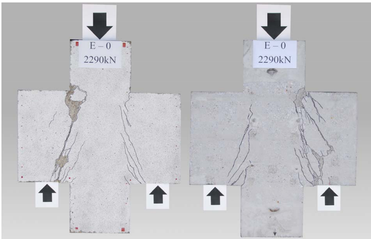
Wspornik po zniszczeniu / Corbel after failure
