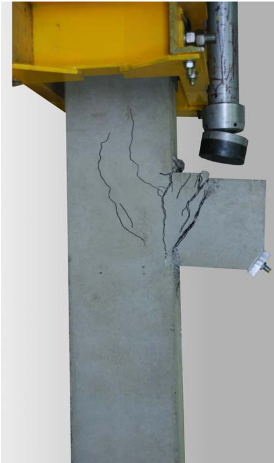
Wspornik po zniszczeniu w stanowisku badawczym / Corbel after failure in test setup
