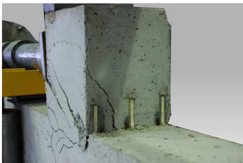
Powierzchnia ściskana po badaniu / Compression surface after test
