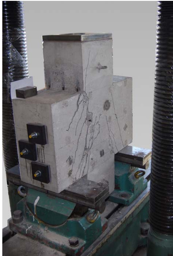
Wspornik po zniszczeniu w stanowisku Corbel after failure in test setup
