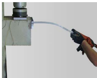
Rys. 3.6. Aplikacja kleju żywicznego Fig. 3.6. Application of resin
