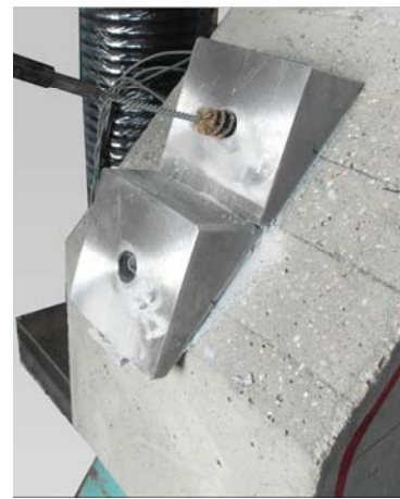
Rys. 3.5. Czyszczenie otworu: a) sprężonym powietrzem, b) drucianą szczotką Fig. 3.5. Cleaning hole with: a) compressed air, b) wire brush
