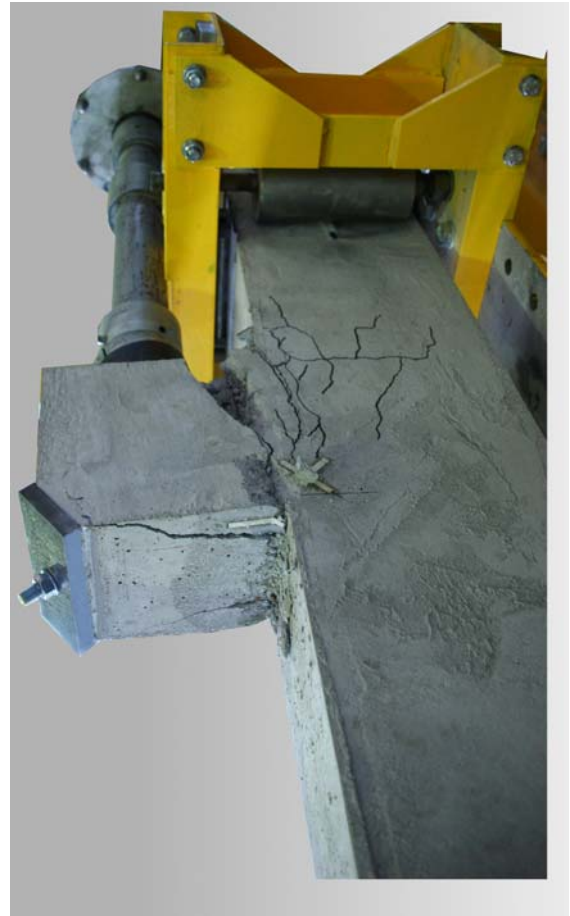
Wspornik po zniszczeniu w stanowisku badawczym / Corbel after failure in test setup
