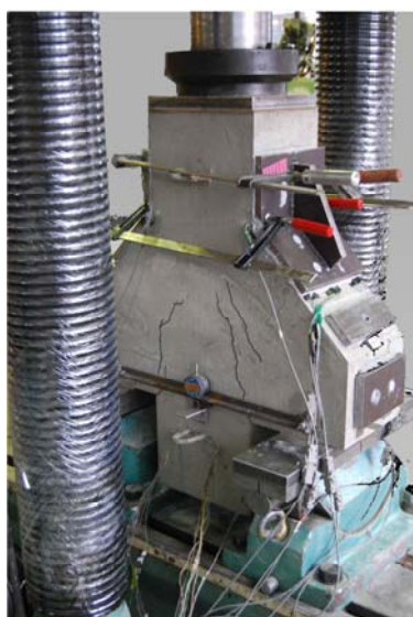
Rys. 3.9. Wzmacnianie elementu D-III – oczekiwanie na związanie warstwy kleju pomiędzy powierzchnią betonu i akcesorium Fig. 3.9. Strengthening of element D-III – waiting for the adhesive to reach full strength between surface of the concrete and accessory
