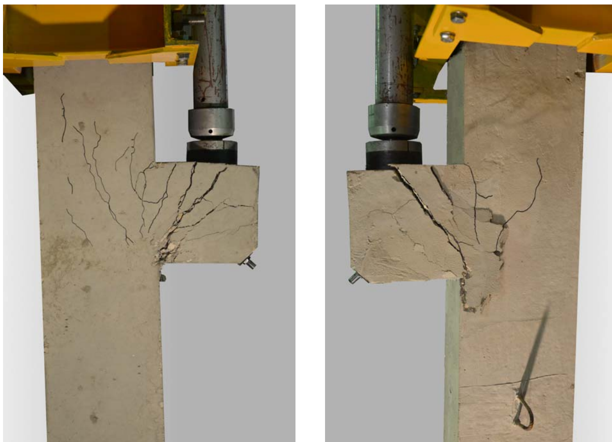
Wspornik po zniszczeniu w stanowisku badawczym / Corbel after failure in test setup
