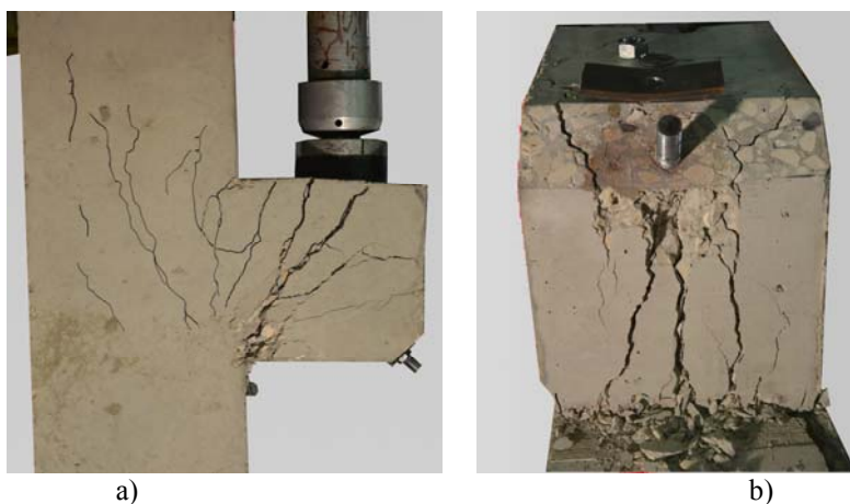
Rys. 3.17. Widok wspornika B – I po zniszczeniu: a) z boku, b) płaszczyzna ściskana Fig. 3.17. View of corbel B – I after failure a) side, b) compressing surface
