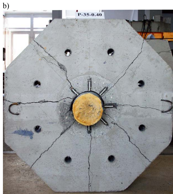
Rys. 3.21. Widok radialnych pęknięć na powierzchni ściskanej płyt modeli serii drugiej a) P30-0.40, b) P-35-0.40 Fig. 3.21. View of the radial cracks on the compression surface of the plates of second series a) P30-0.40, b) P-35-0.40
