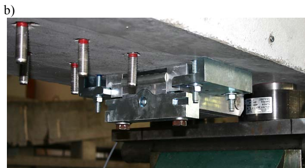
Rys. 2.13. Szczęki zaciskające taśmę zamontowane na szynach: a) strona czynna, b) strona bierna Fig. 2.13. Anchorage clamps mounted on the steel rails: a) the active side, b) the fixed side
