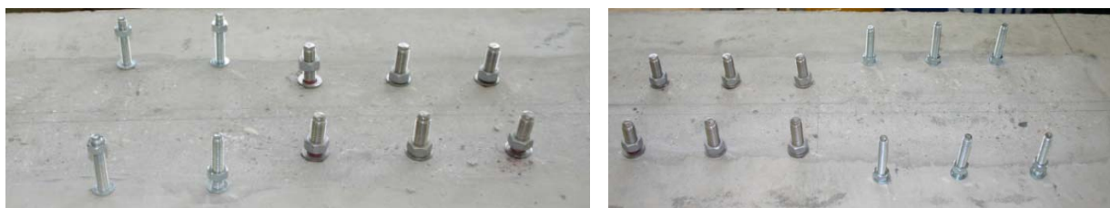
Rys. 2.12. Widok powierzchni belki z zamocowanymi kołkami: strona bierna (z lewej) i strona czynna (z prawej) Fig. 2.12. View of the beam's surface with the mechanical bolts: passive - fixed side of the system (on the left) and the active - movable side of the system (on the right)
