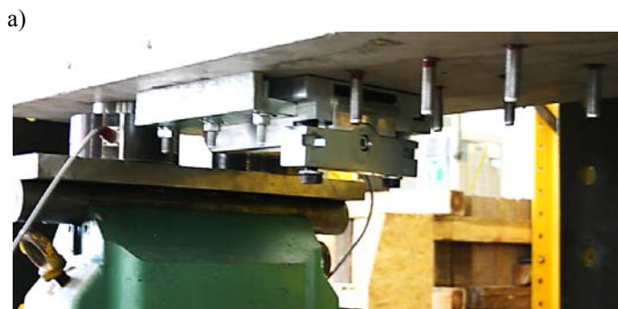
Rys. 2.13. Szczęki zaciskające taśmę zamontowane na szynach: a) strona czynna, b) strona bierna Fig. 2.13. Anchorage clamps mounted on the steel rails: a) the active side, b) the fixed side
