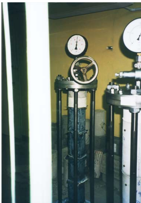
Rys. 2.1. Próbki K-F2m i K-2Ftm poddane wstępnemu obciążeniu przed przyklejeniem materiałów CFRP, po wykonaniu tej czynności
