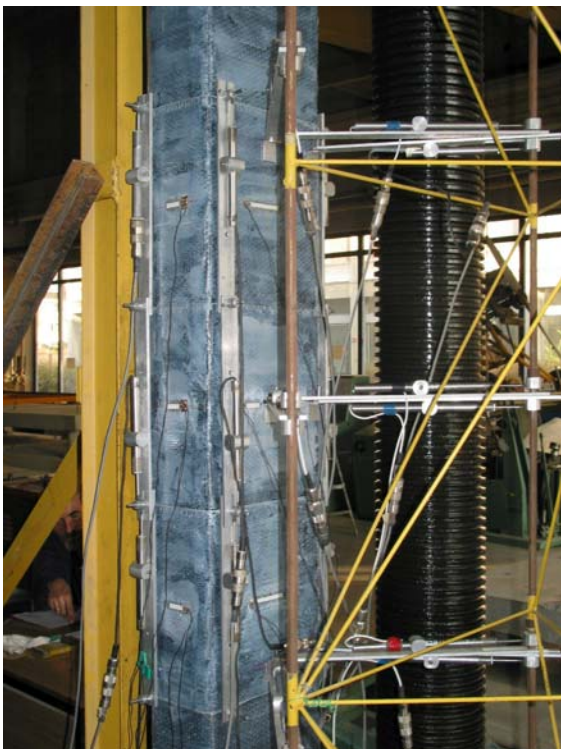
Rys. 2.12. Oprzyrządowanie do pomiaru odkształceń i przemieszczeń słupa Fig. 2.12. The strain and displacement measurement equipment
