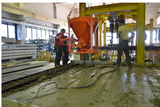
Rys. 2.7. Betonowanie belek Fig. 2.7. Casting of beams
