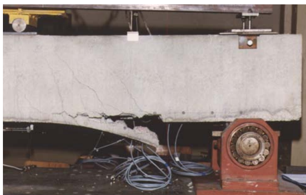
Rys. 4.1. Postęp zniszczenia belki B-04/S Fig. 4.1. The mode of failure of the beam B-04/S
