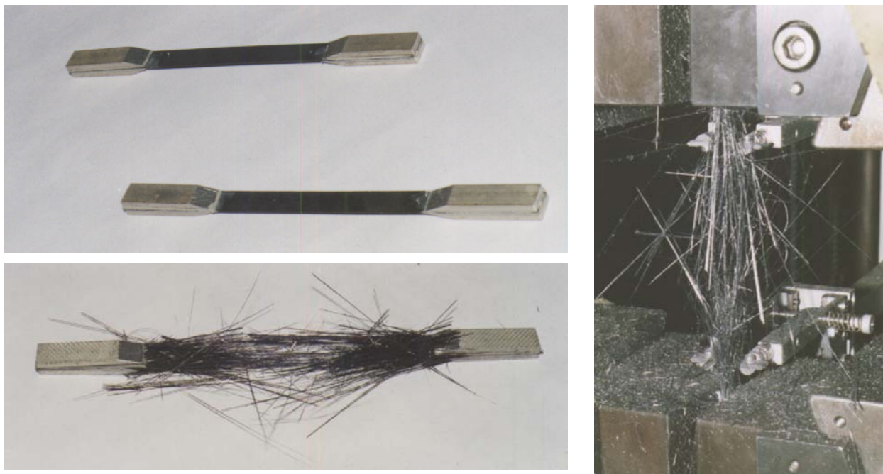
Rys. 3.4. Taśma CFRP przed badaniem, po badaniu oraz w maszynie wytrzymałościowej w chwili zniszczenia Fig. 3.4. CFRP strip before and after the test and in strength testing machine at failure
