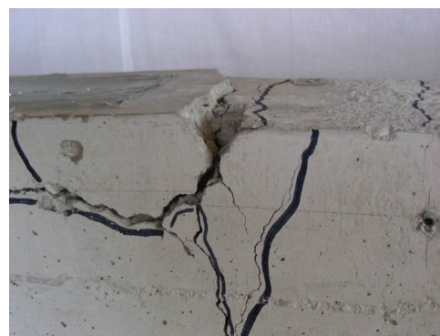
Rys. 5.2. Typ zniszczenia B (z zewnętrzną matą) Fig. 5.2. Failure mode „B” (externally bonded sheet)
