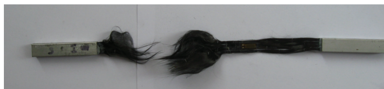
Rys. 4.3. Próbkę mat CFRP po zniszczeniu Fig 4.3. CFRP sheets after failure
