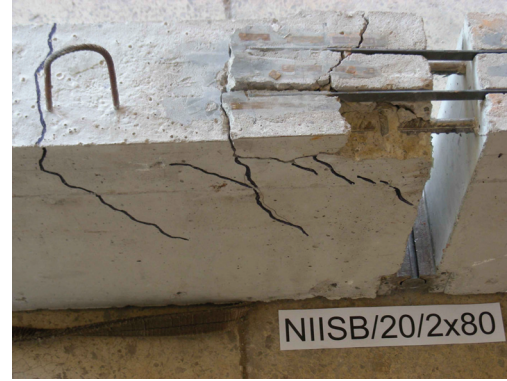
Rys. 5.4. Typ zniszczenia „B” (dwie wklejone taśmy) Fig. 5.4. Failure mode „B” (double NSM strips)
