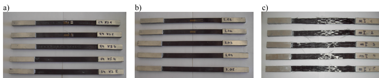
Rys. 3.2. Próbkki materiałów CFRP a) taśmy XS1524, b) taśmy S914, c) maty HEX 230C Fig. 3.2. CFRP specimens a) strips XS1524, b) strips S914, c) sheets HEX 230C
