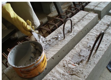
Rys. 3.10. Sposób aplikacji materiałów CFRP: a) przyklejanie mat, b) wklejanie taśm w bruzdy betonowej otuliny Fig. 3.10. Mode of application of CFRP materials a) externally bonded sheets, b) NSM strips
