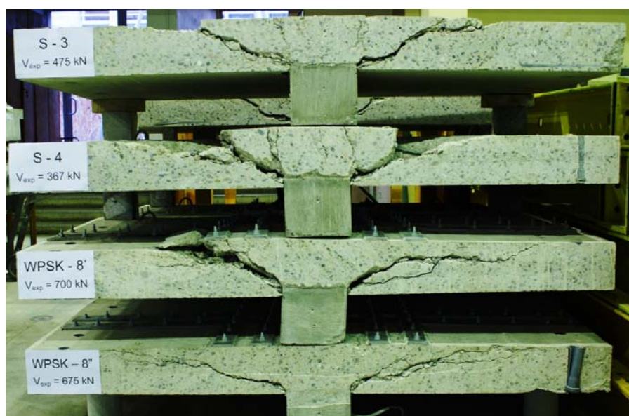
Rys. 5.4. Modele serii trzeciej po przecięciu płyt w licu słupa Fig. 5.4. Third series models after cutting the slabs in column face
