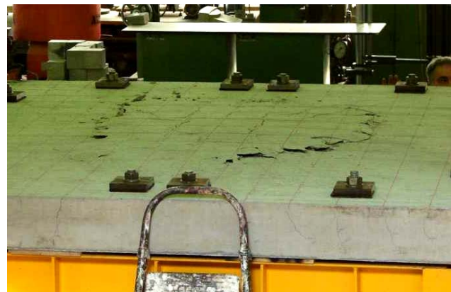
Rys. 3.7. Model S-1 po zniszczeniu Fig. 3.7. Model S-1 after failure
