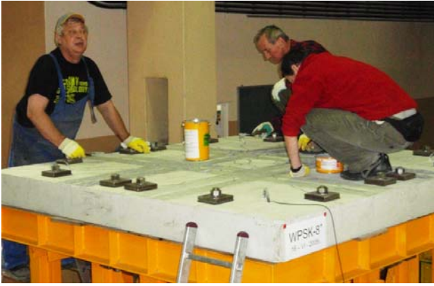
Rys. 5.2. Rozkładanie kleju na płycie modelu WPSK-8''
