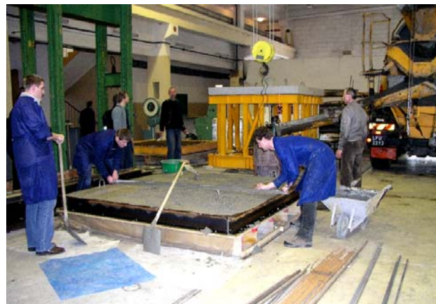
Rys. 2.3. Betonowanie modeli z wykorzystaniem betonu towarowego
