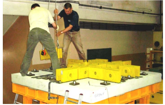
Rys. 5.3. Dociskanie płaskowników po ich ułożeniu na warstwie kleju
