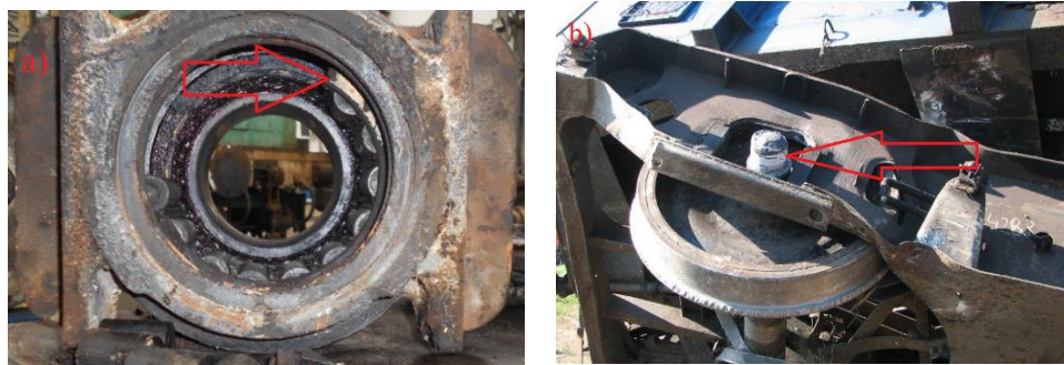
Rys. 3. Skutki uszkodzenia łożyska osiowego:
