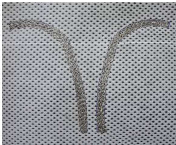
Rys. 7. Promiennik anteny tekstylnej wytworzony metodą haftu
