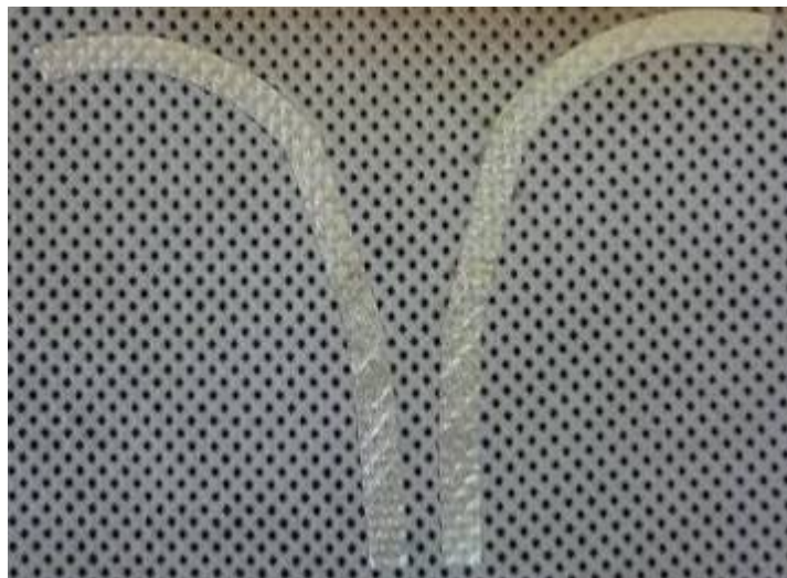
Rys. 5. Promiennik anteny tekstylnej wytworzony metodą rozpylania magnetronowego
