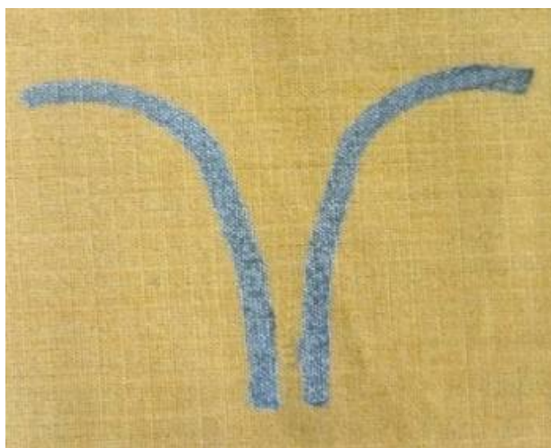
Rys. 6. Promiennik anteny tekstylnej wytworzony metodą drukowania
