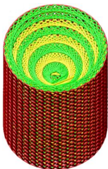
Rys. 3.7. Przykład dzianiny przestrzennej w kształcie walca
