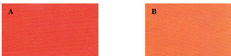
Rys. 6. Zdjęcia bawełnianych próbek drukowanych pastą zawierającą TTC po napromienianiu UV o dawce 1 \text{ J/cm}^2 oraz (A) oraz 50 \text{ J/cm}^2 (B) [52]
