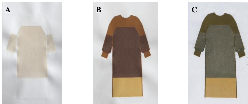
Rys. 21. Fotografia przykładowego ubrania ochronnego: A: bawełniane ubranie po drukowaniu; B: to samo ubranie po napromienieniu UVC ( 5 \text{ J/cm}^2 ) oraz C: po 1 cyklu prania [39]
