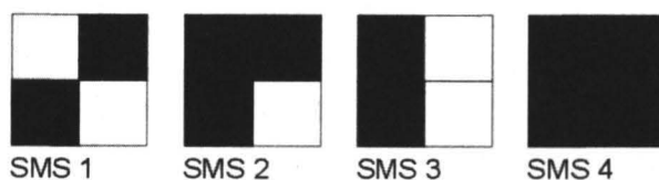
Rys. 1. Tkacka notacja splotowych modułów strukturalnych (SMS). Źródło [3, 4] J. Szosland.
