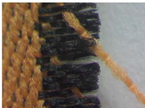
Rys. 2. Widok konstrukcji tkaniny blackout z czarnym wątkiem; fragment o wymiarach 7 mm × 5,25 mm
