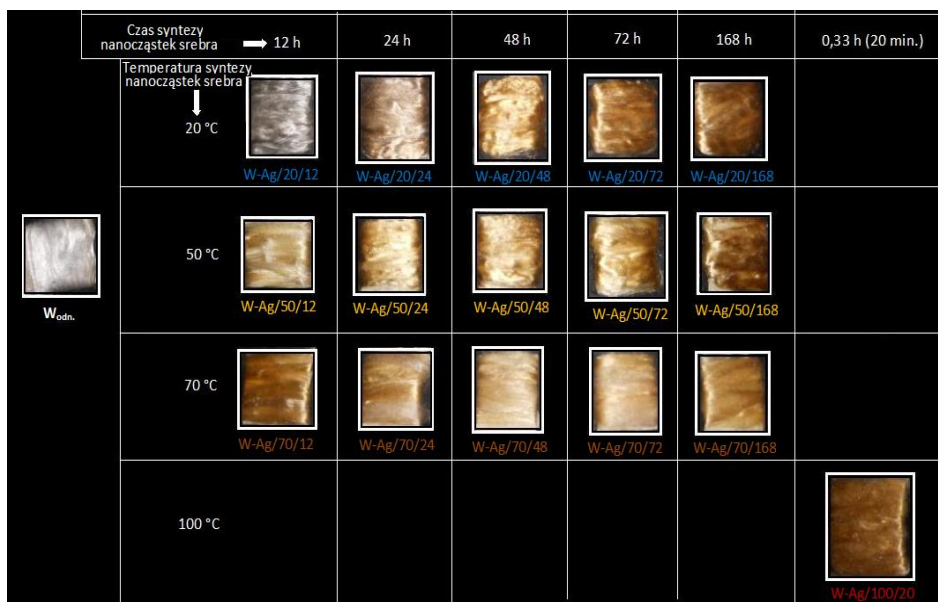
Rys. 17. Zdjęcie otrzymanych włókien modyfikowanych nanocząstkami srebra oraz włókna odniesienia W odn.
