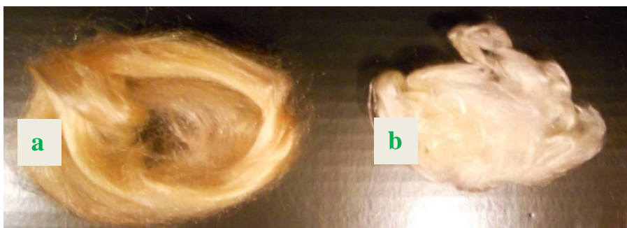
Rys. 16. Zdjęcia włókna W-Ag/70/24 z nanocząstkami srebra przed (a) i po (b) badaniu aktywności antybakteryjnej
