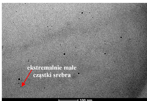
Rys. 8. Obraz nanocząstek srebra we włóknach W-Ag/70/12 wykonane metodą TEM: obrazy nanocząstek w „jasnym polu”
