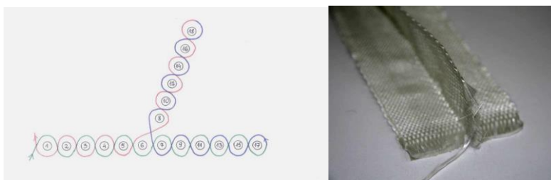
Rys. 1. Przekrój wzdłuż wątku tkaniny przestrzennej (widok w fazie rozkładania) i przykładowa tkanina o T-owym kształcie przekroju
