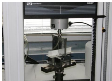
Rys. 3. Badanie wytrzymałości na zginanie kompozytów na maszynie wytrzymałościowej
