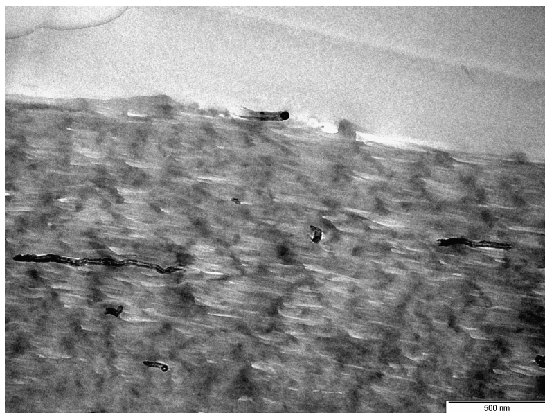
Rys. 5. Obraz przekroju wzdłużnego włókna zawierającego nanorurki węglowe
