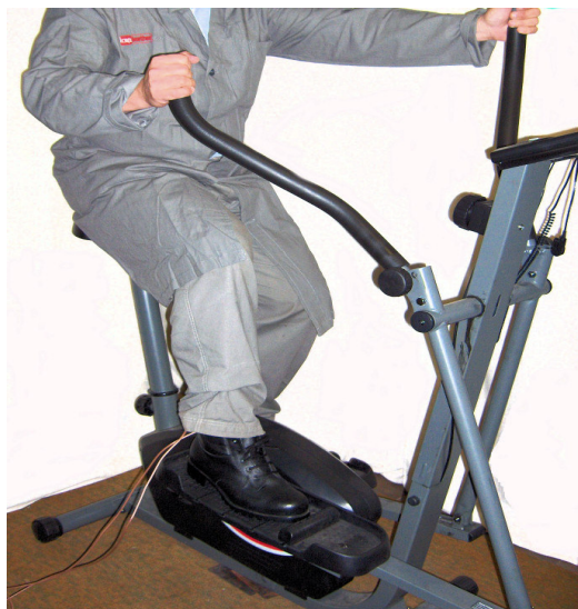
Rys. 2. Faza wysiłkowa podczas badania obuwia typu trzewik
